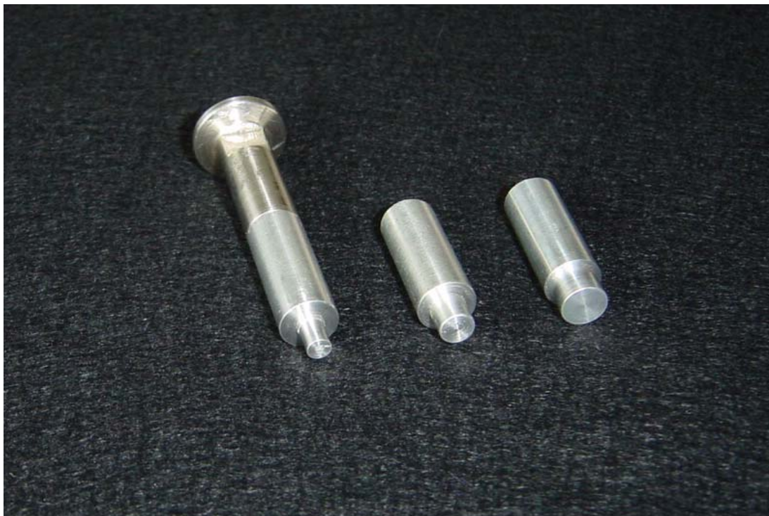
Abbildung 3-4: Oberstempel mit verschiedenen Durchmessern (4, 6, und 8 mm)
