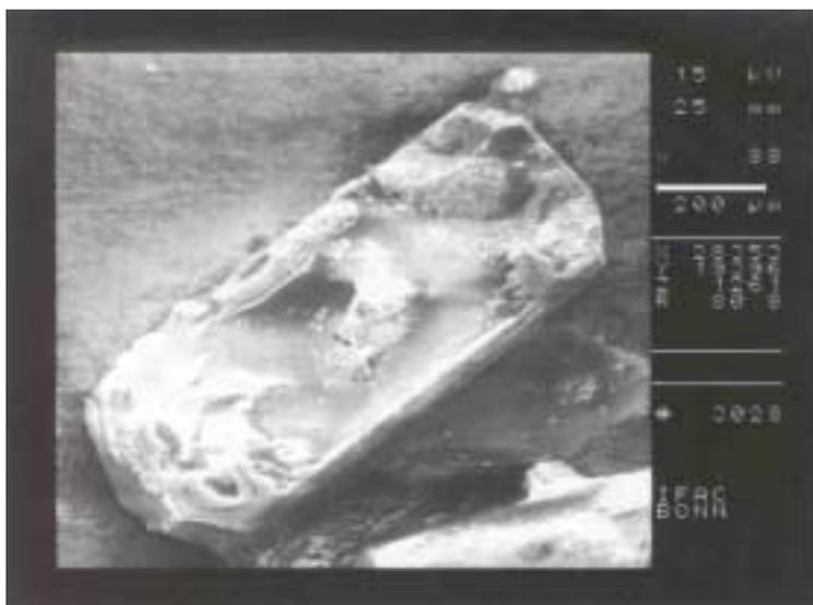
**Abb. 8.4:** Rasterelektronenmikroskopische Aufnahme eines (As<sub>3</sub>S<sub>5</sub>)[AlCl<sub>4</sub>]-Kristalls.
