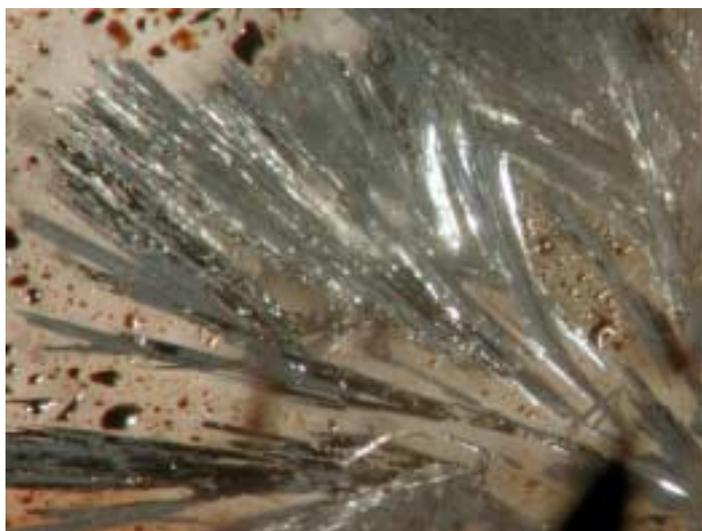
**Abb. 3.1:** Kristalle von  $(\text{Bi}_2\text{Te}_2)\text{Cl}[\text{AlCl}_4]$ .
