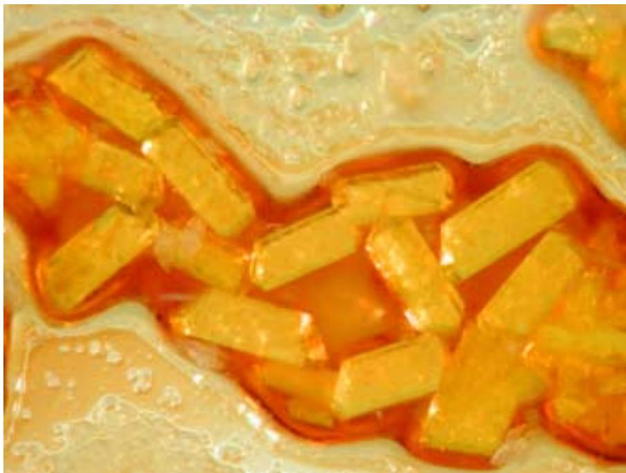
**Abb. 8.2:** Kristalle von  $(\text{As}_3\text{S}_5)[\text{AlCl}_4]$ .
