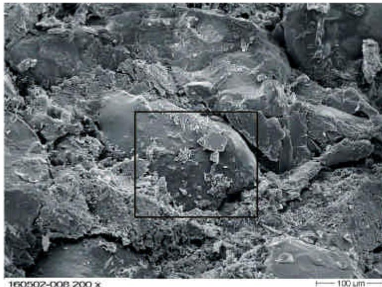
Abbildung IV.9 REM-Aufnahme von überzogenen ASS-Kristallen in der Brausetablette 200 fache Vergrößerung
