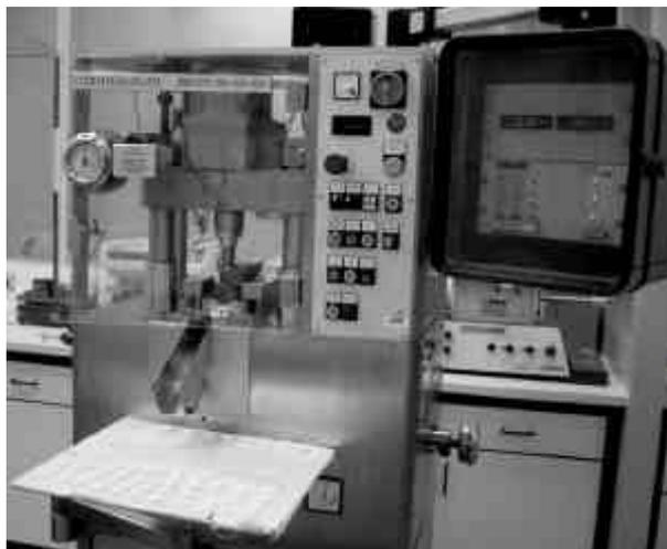
Abbildung III.19: hydraulische Exzenterpresse SP300 der Firma Killian
