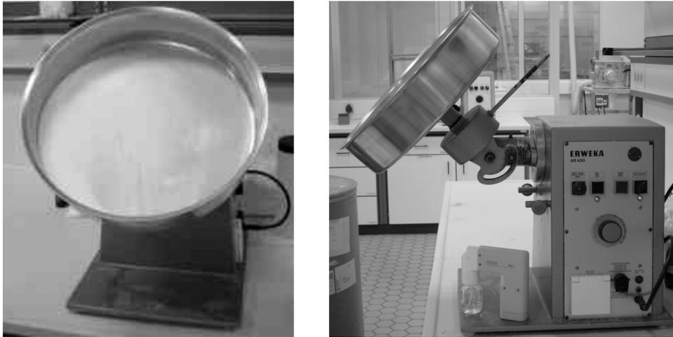
Abbildung III.18: Granulierteller der Firma Erweka (Front- und Seitenansicht)
