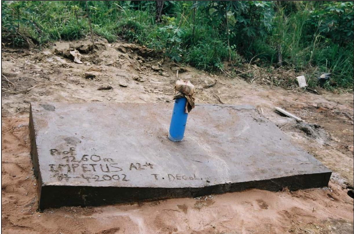
Abb. 2.18: Oberirdische Betonterrasse von Grundwasserbeobachtungsbohrung GWB3.
