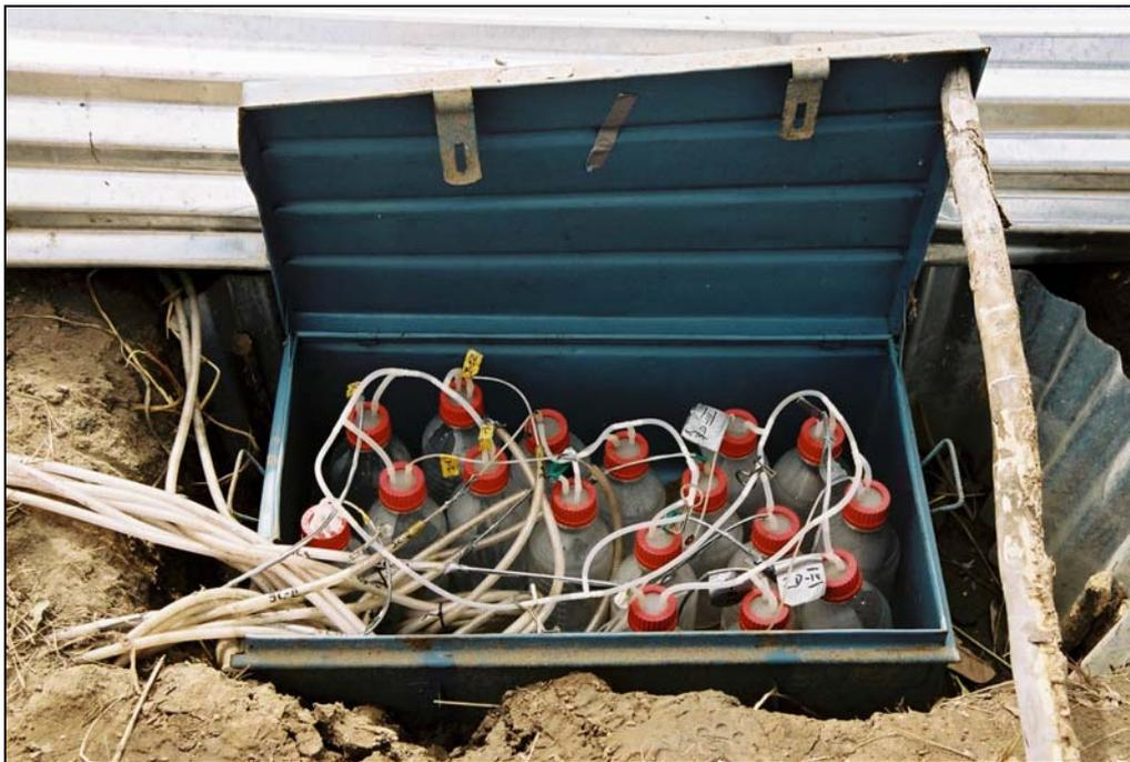
Abb. 3.7: Aufbewahrungsgrube für an die Saugkerzen angeschlossene Sammelflaschen. Zum Schutz gegen Feuchte und Tierfraß wurden die Sammelflaschen in einer Aluminiumkiste verwahrt. Die ca. 1 m tiefe Grube ist vor Überflutung durch starkregen Ereignisse mit einem Wellblechdeckel versehen.
