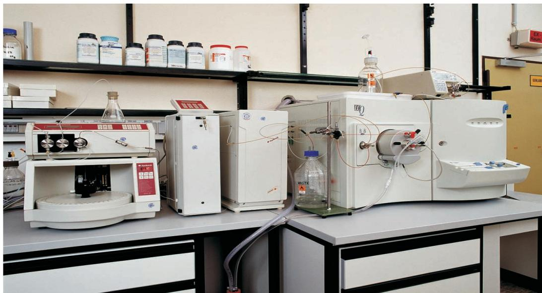
ABBILDUNG 5.3.: Foto der Ionenfallen LC-MS Anlage.
