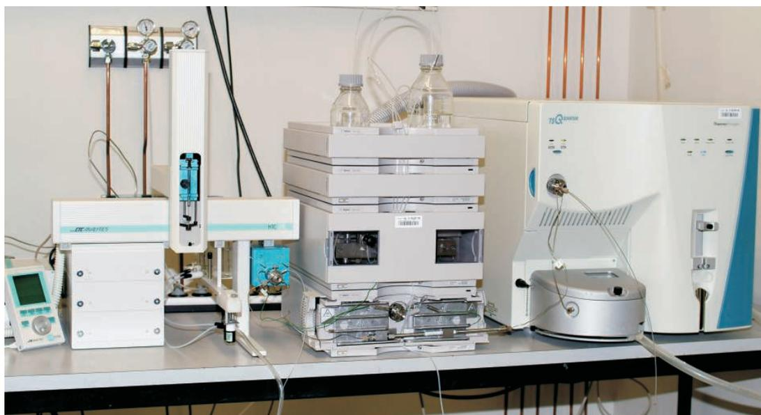
ABBILDUNG 5.4.: Foto der Triple Quadrupol LC-MS Anlage.
