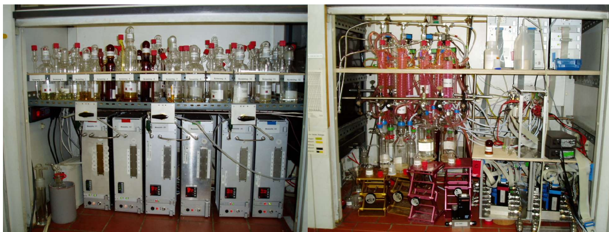
Abbildung 16: Foto der Multi-Komponenten Gasmischanlage; linke Hälfte: 6 Messkammern für je 12 QMBs mit Temperaturregeleinheit; rechte Hälfte: Bubblerflaschen mit Schlangenkühlern (links) und Massedurchflussregler (rechts unten)
