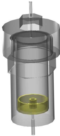
Abbildung 18: Transparente technische Zeichnung des angefertigten Autoklaven.
