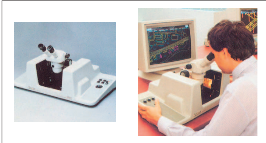
Abb. 6.2.1.4: Das PC-gesteuerte analytische Auswertegerät Micro-Photogrammetric System (MPS 2) von ADAM Technology (Quelle: ADAM Technology 1990)
