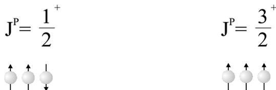
Es ergibt sich eine Zusammenstellung aus zwei Quarks mit einem parallelem und einem antiparallelem Spin. Diese koppeln zu  $J^P = 1/2^+$ . Die andere Möglichkeit, wobei alle Quarks parallelen Spin besitzen, koppelt zu  $J^P = 3/2^+$  (siehe Abbildung 2.1).
