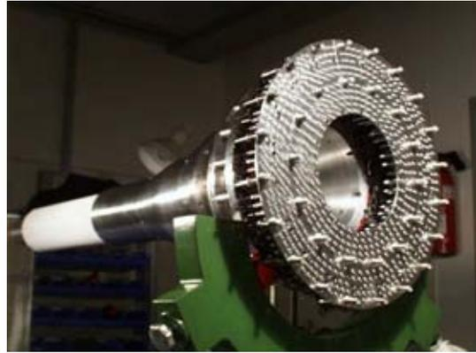
Abbildung 3.8: Innen-Detektor vor der Montage im Crystal-Barrel-Detektor
