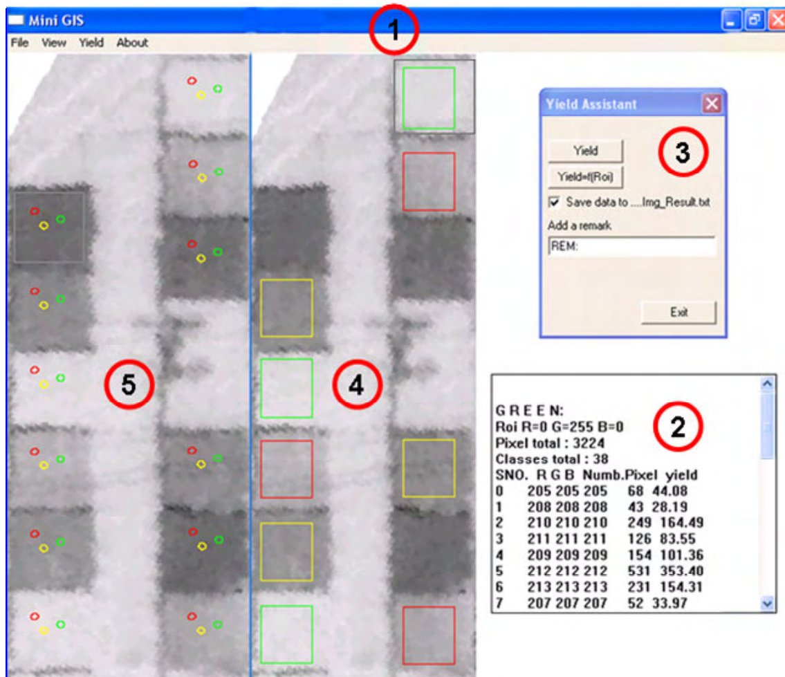
Abb. 3.8 Oberfläche der Software MiniGis ® zur Auswertung von Rasterdaten. (1) zeigt das gesamte Programm mit geladener Rasterkarte (hier QuickBird -NDVI-Bild) und überblendeter Region of interest (Roi) (rote, gelbe und grüne Kreise und Rechtecke). Im rechten Teil (2) ist das Ergebnis der Auswertung der grünen Roi abzulesen. „SNO“ bezeichnet die sample number, „RGB“ die zugehörigen Grauwerte, „Numb.Pixel“ die Anzahl an Pixeln mit entsprechenden RGB-Werten und „Yield“ den Gesamtertrag (Kornertrag, NDVI-Wert usw.) aus allen Pixeln. Mit dem Yield Assistant (3) können die Werte gespeichert und benutzerdefiniert benannt werden. In den Karten (4) und (5) ist beispielhaft die Parzellen- (Rechtecke) sowie Bonitурpunkttauswertung (Kreise) dargestellt.
