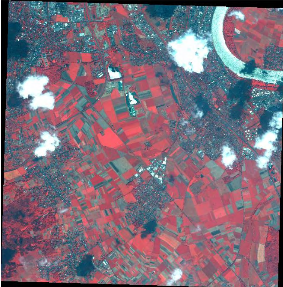
A-Abb. 8.1 QuickBird -Satellitenbild vom 25. 06. 2002 über der Region Wesseling/Bonn; multispektraler Modus in der Kanalkombination 4-2-1 (RGB) mit 2,8 m räumlicher Auflösung und einer Ausdehnung von 8 x 8 km 2 ; In der Bildmitte liegt die Lehr- und Forschungsstation Dikopshof, oben rechts ist der Rhein und die weißen „Wattebäusche“ sind Wolken.
