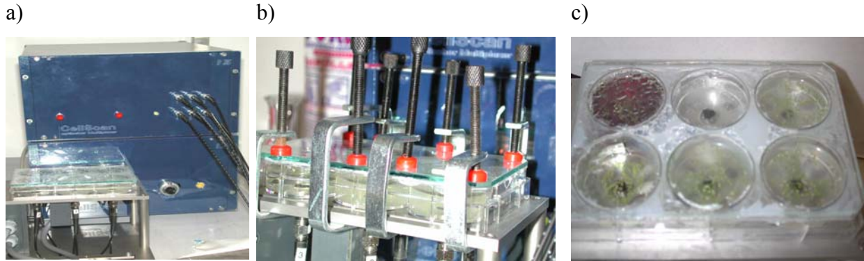
Abb. 8) Cell-Scan-Anlage mit Meßtisch (a), Versuchsaufbau mit Glasplatte und Schraubzwingen (b) und 6-Well-Platte mit schwarzen Sensoren (c)
