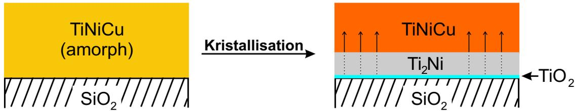
**Abbildung 6.5:** Schema der Phasenbildung während der Kristallisation eines TiNiCu-Films. Die Pfeile deuten die Bewegungsrichtung der Kristallisationsfront an.
