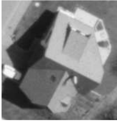
Abbildung 7.3: Um die Ecke zu entfernen, die zwar im Modell, nicht aber im Luftbild enthalten ist, kann eine CSG-Operation zum Einsatz kommen, die den Durchschnitt (bzw. Differenz) mit einem Halbraum bildet.
