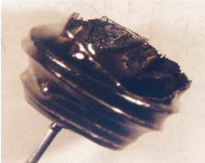
Abbildung 5.62: Angegriffener Tantaliegel (Innendurchmesser: 0,5 mm) mit erstarrtem Basaltglas des Mondstaub-Simulats nach der Bestrahlung. Die beim Aufschäumen übergelaufene, schwarze Basaltschmelze umhüllt vollständig den Tantaldraht, der die Tantschale hält. Der vormals gerade Rand der Schale wurde durch die aggressive Schmelze fast überall aufgelöst.
