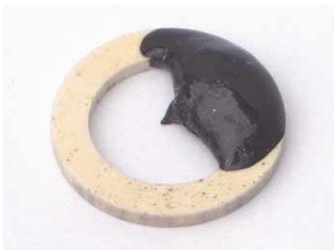
Abbildung 5.30: Probe MS2 nach der Bestrahlung. Die blasenreiche Schmelze erstarrte als Basaltglas auf dem Begrenzungsring. Auf dem Ring aus Aluminiumoxid sind außerdem kleine Spritzer der Probe zu sehen.
