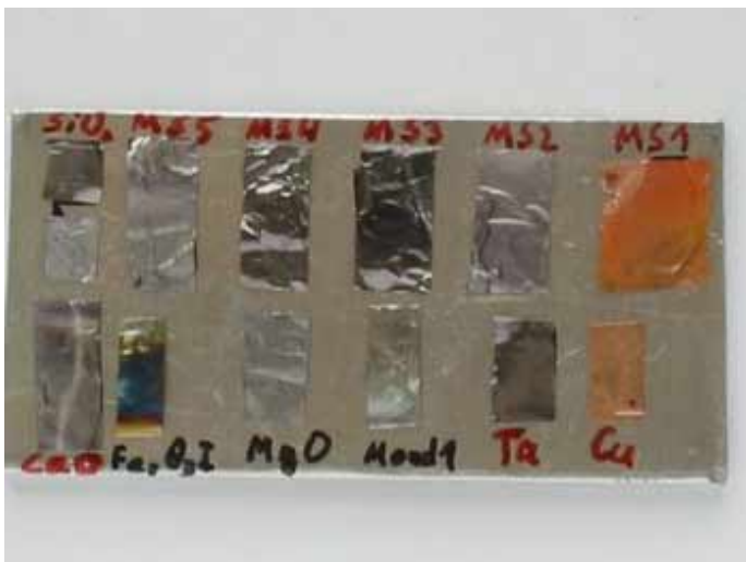
Abbildung 4.11: Ausgewählte Bereiche der verwendeten Kühlfallenfolien sowie zwei unbestrahlte Referenzproben (Ta, Cu) wurden ausgeschnitten und für weitere Untersuchungen mit einer elektrisch leitenden Folie auf eine Trägerplatte aus Aluminium aufgeklebt. Neben den Folien (MS1 bis MS5, CaO und SiO) der letzten Versuchsreihe wurden noch einige Folien der Vorversuche ( \text{Fe}_2\text{O}_3 , MgO, Mond1) aufgeklebt.
