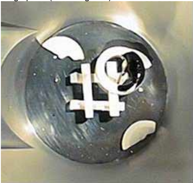
Abbildung 5.63: Erstarrte Mondstaub-Simulat Probe auf keramischem Träger mit zerstörter Aluminium-oxidplatte. Die Platte sprang nach dem Schließen des Shutters durch einen Temperaturschock.
