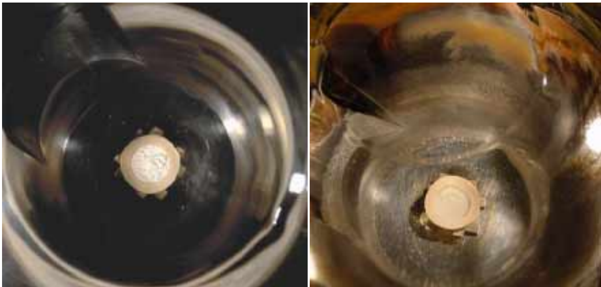
Abbildung 5.16: Bestrahlungsbereich mit der Probe ZnO vor (links) und nach (rechts) der Bestrahlung. Durch die Reaktion der Probe, bei der die Probenmasse fast vollständig verbraucht wurde, wurde der Innenraum stark bedampft.
