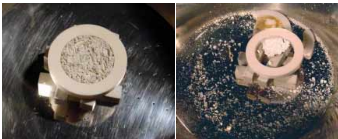
Abbildung 5.7: \text{CaO} -Probe vor (links) und nach (rechts) der Bestrahlung. Das Probenpulver war durch das Aufheizen gesintert worden und stellenweise sogar geschmolzen. In der Abkühlphase war die Probenträgerplatte aufgrund von Thermospannungen gesprungen.
