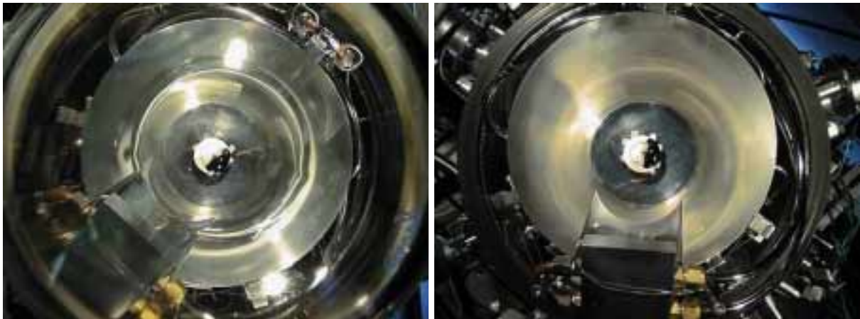
Abbildung 5.35: Bedampfung der gekühlten Aluminiumabschirmung, die erst nach der Belüftung der Kammer milchig wurde. Links ist der gut reflektierende Innenaufbau vor dem Belüften zu sehen. Rechts zeigt ihn danach mit deutlichem Belag.
