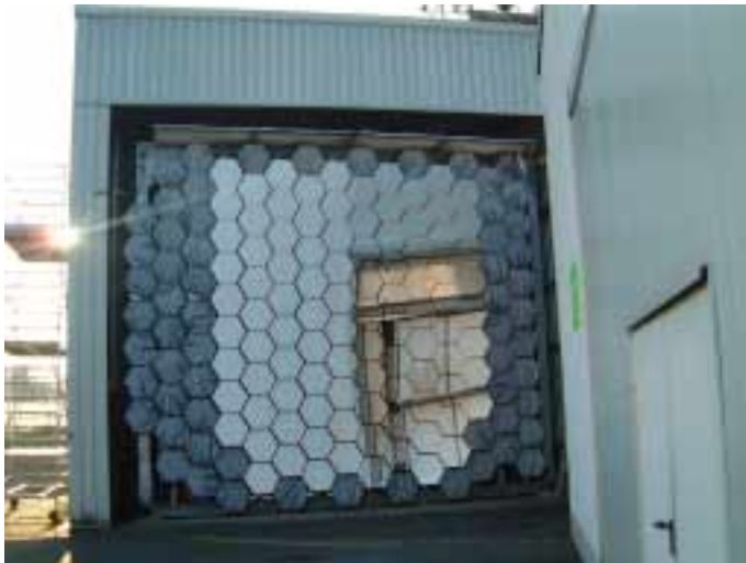
Abbildung 3.13: Teilweise zugehängtes Facettenfeld des Konzentrators (39 % der Spiegel) zur Optimierung des Sonnenofenstrahls bzgl. Form und Leistung, um die Glaskuppel der Vakuumkammer zu schützen.
