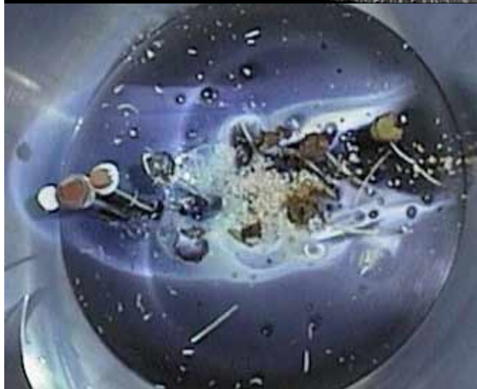
Abbildung 5.60: Oxidierte Tantal­proben­träger mit mineralischen Proben in der Vakuumkammer nach der Bestrahlung. (Versuche zur Chondren­Bildung bei einem Vakuum von rund 1 mbar) Während die weniger stark erhitzen Draht­ständer am Rand nur oberflächlich oxidierten, wurden mehrere Träger im Zentrum des Sonnenofen­strahls vollständig zerstört.
