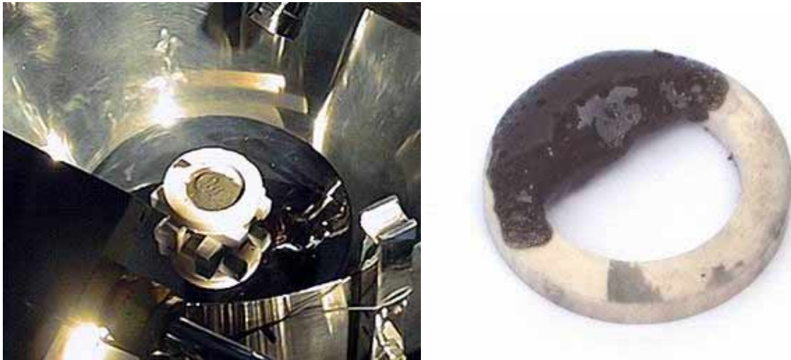
Abbildung 5.17: Pulverprobe MS1 in der Vakuumkammer vor (links) der Bestrahlung und im erstarrten Zustand danach (rechts). Die blasenreiche Schmelze erstarrte als Basaltglas auf dem Begrenzungsring aus Aluminiumoxid, auf dem auch kleine Spritzer der Probe zu sehen sind.
