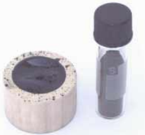
Abbildung 5.47: Probe MS5 nach der Bestrahlung. In der Mitte der aufgeschäumten Basaltglasschmelze hat sich ein Loch gebildet, das offensichtlich beim Aufplatzen einer großen Gasblase entstanden ist. Rechts im Glas ist die nicht geschmolzene Restmenge (54 Gew.%) des Granulats zu sehen. (Tiegel: Ø = 25 mm, Höhe = 30 mm)
