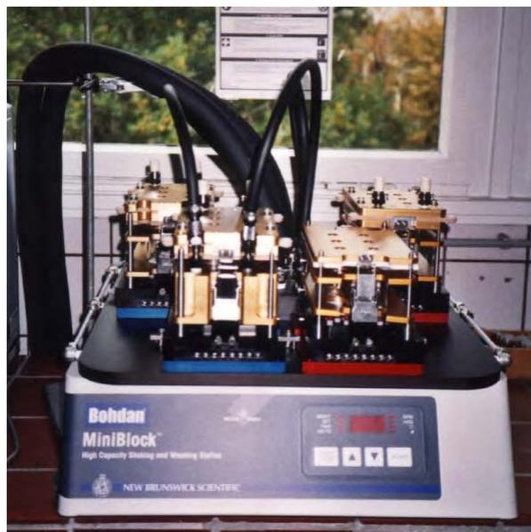
**Abb. 38:** Bohdan MiniBlock<sup>®</sup>-Synthesemaschine zur parallelen Festphasensynthese.
