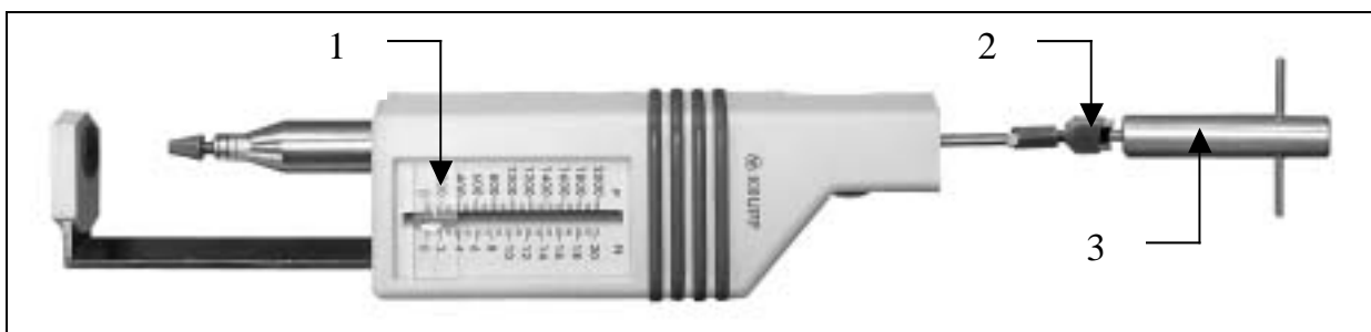
Abb. 11: Friktionstester: 1 Kraftskala mit 1,5 Newton Abzugskraft, 2 Primär- und Sekundärteleskop, 3 Abzugshilfe
