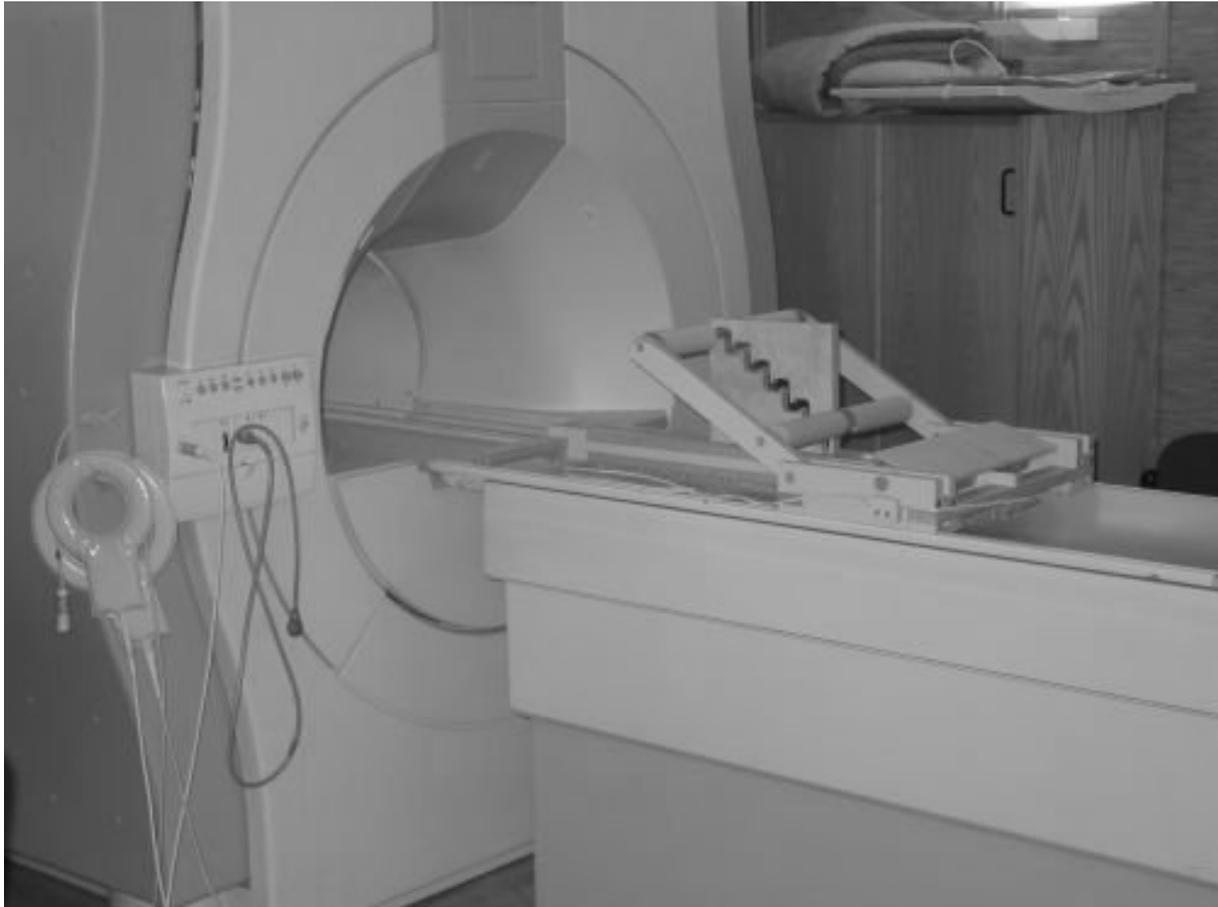
**Abbildung 1: Halteapparat auf Positionierungstisch**
