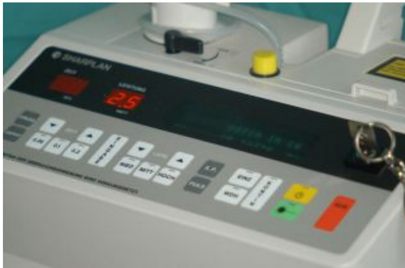
Abb. 4: Bedienungstableau des Sharplan 20C CO 2 -Laser
