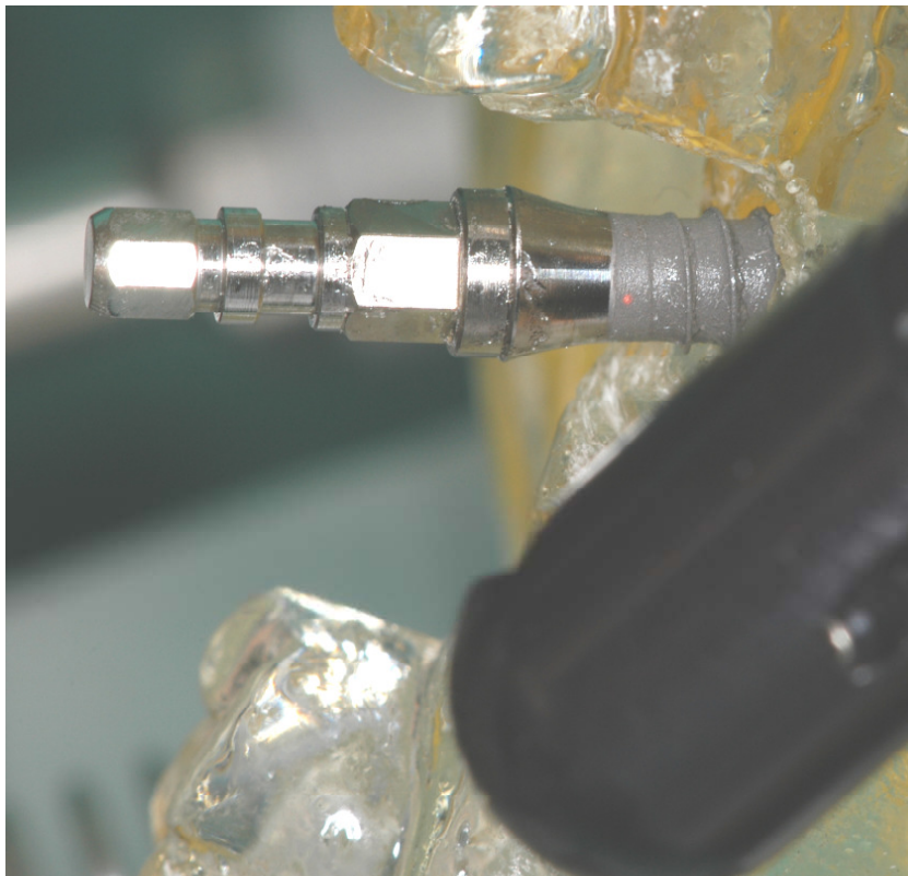
Abb. 13: Implantat wird mit dem CO 2 -Laser (roter Laserspot) bestrahlt
