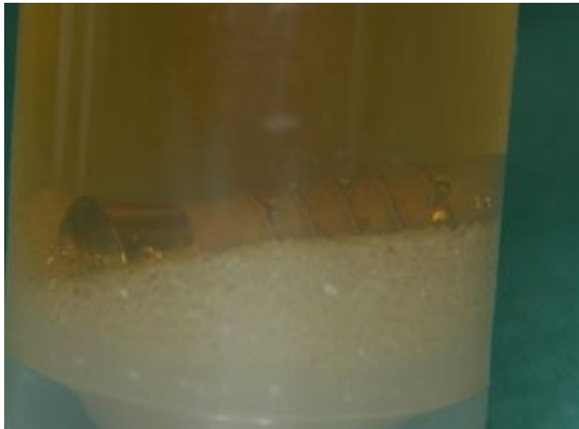
Abb. 14: Implantat im Schraubröhrchen mit CaSo-Bouillon und Glasperlen
