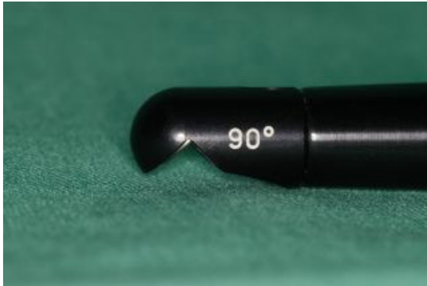
Abb. 5: 90°-Optik-Handstück des Sharplan CO 2 -Lasers
