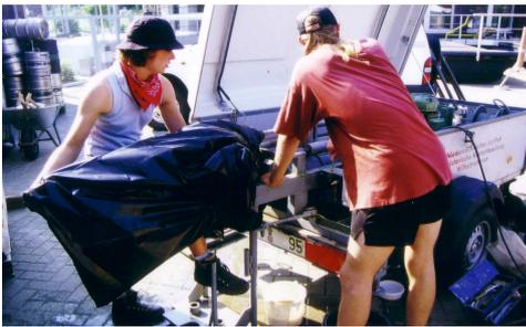
**Abb. 5.9:** Auspressen des Bohrkerns unter Lichtausschluss.
