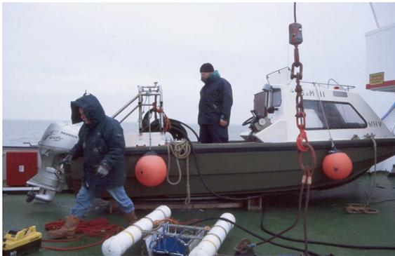
**Abb. 3.4:** SAM II, das Beiboot des FK Senckenberg. Im Vordergrund der Boomer, der zwischen zwei Schwimmern installiert ist.
