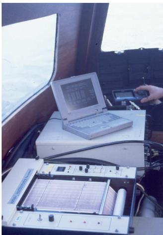
**Abb. 3.6:** Analoges Aufzeichnungsgerät und DGPS in der Kajüte der SAM II.
