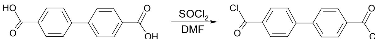
Zu 10 ml (134 mmol) Thionylchlorid gibt man einige Tropfen DMF und 5,00 g (20 mmol) Biphenyl-4,4'-dicarbonsäure und erhitzt unter Rückfluß. Nach 5 h wird das überschüssige
