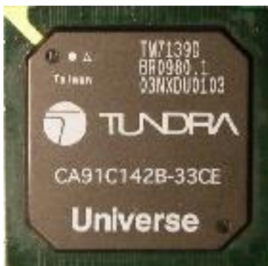
Bild eines Tundra Universe II Chips für den Zugriff auf den VME-Bus
