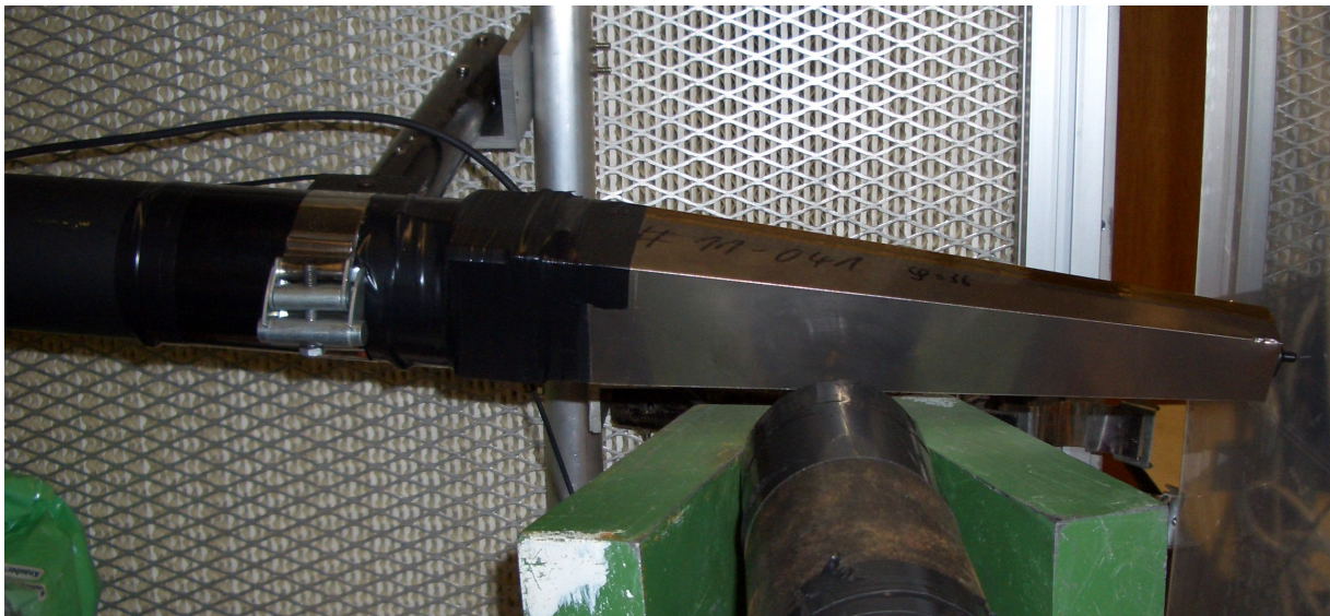
Abbildung 7.7 Kristall in Titanhülle mit Photomultiplierauslese. Unter dem Kristall befindet sich ein Plastiksziintillator, der ebenfalls über einen Photomultiplier ausgelesen wird.
