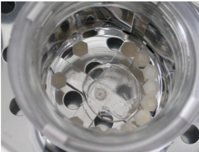
Abb. 12: Versuchsaufbau zur Pellikelbeschichtung: Schmelzproben in steril-filtrierte Speichel im Schüttelbad
