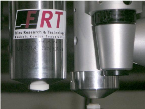
Abb. 10: Kombination der Messköpfe beim FRT MicroGlider®
