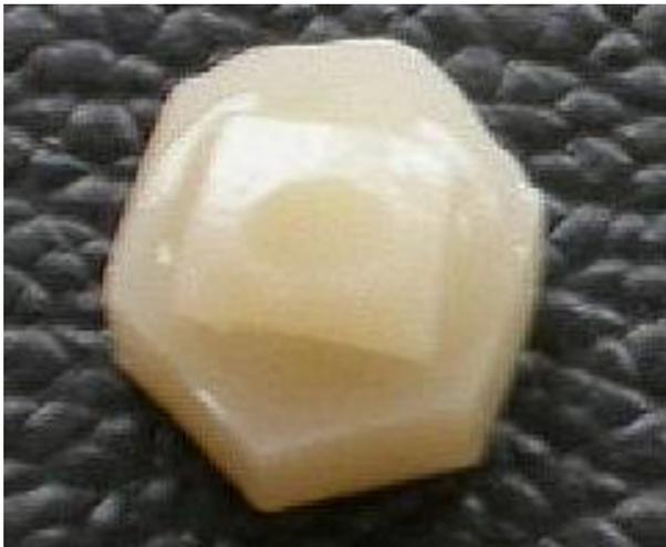
Abb. 11: Standardisierte Schmelzprobe für die Versuchsreihen: Kariesfreier Schmelz eingebettet in Kunststoff, nach dem ersten Schleifvorgang
