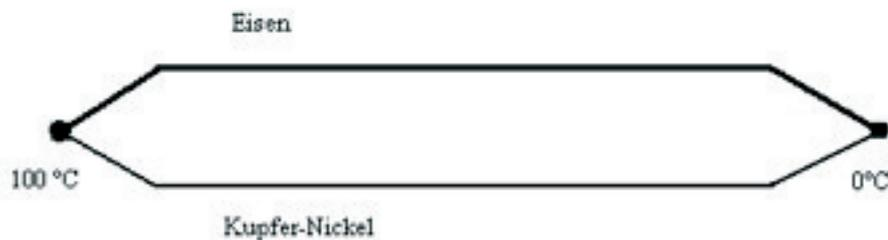
Abb. 3: Prinzip des Thermoelements
