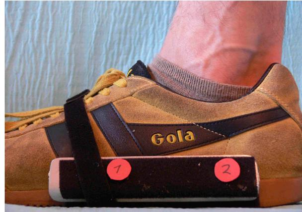
Abb. 11: Messschiene Fuß, am Fußaußenrand angebracht, mit Senderpositionierung von lateral gesehen, (eigene Fotografie)
