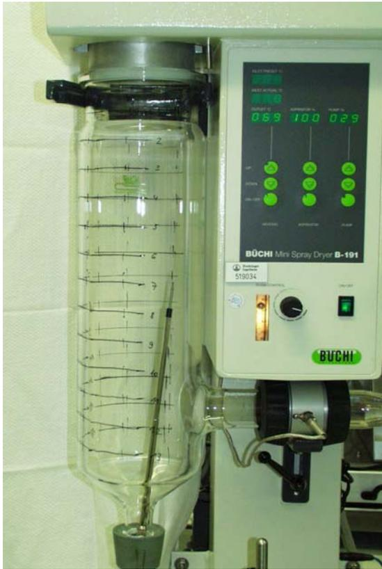
**Abb. 44: Sprühzylinder des Laborsprühtrockner B191 mit Kugelkopfanemometer**
