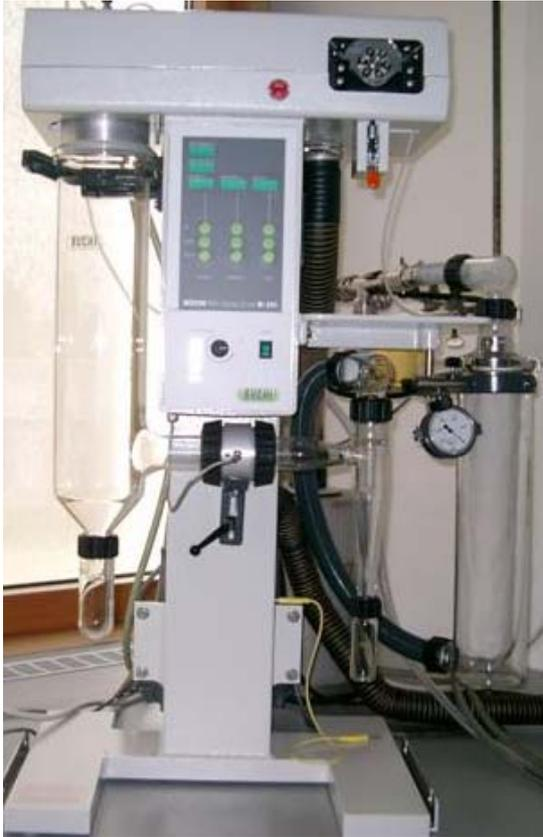
Abb. 6: Laborsprühtrockner B 191 der Firma Büchi (Schweiz) mit High Performance Zyklon
