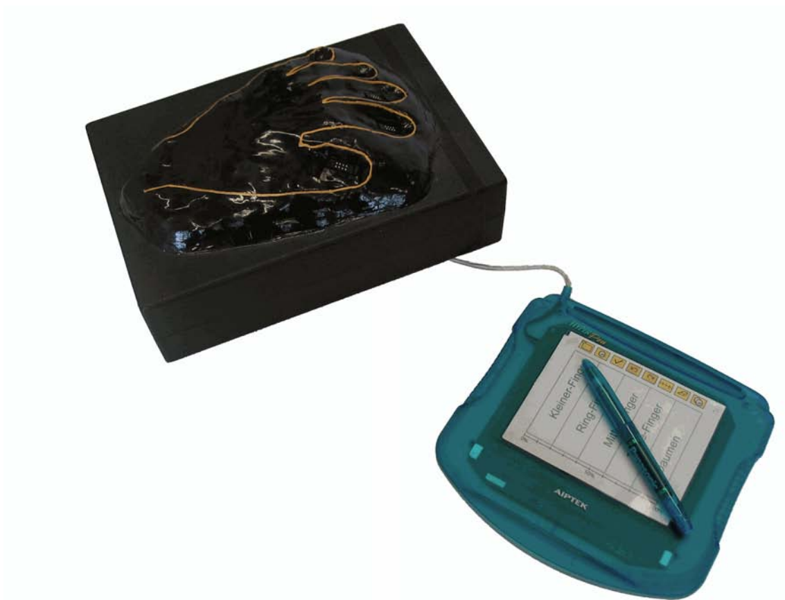
Abbildung 5-7: Versuchsaufbau zur direkten Eingabe von Stimulationsparametern. Links oben ist der taktile Stimulator dargestellt und rechts unten das Touchpad mit dem dazugehörigen Eingabestift.
