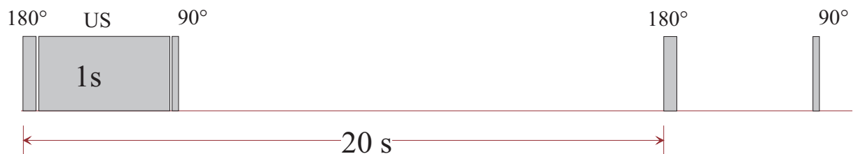
Abbildung 7.2: Messsequenz zur Bestimmung der T_1 -Zeit mit und ohne Ultraschall mit einer Inversion-Recovery-Sequenz in die die Ultraschalleinstrahlung wie abgebildet integriert wurde.
