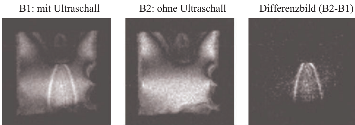
Abbildung 11.7: Dargestellt sind Aufnahmen, welche mit einer T_2 - gewichtete Sequenz von Wasser aufgezeichnet wurden. Während der Sequenz zu Bild B1 wurde Ultraschall eingestrahlt. Das Bild B2 ist ohne Ultraschall aufgenommen worden und das Bild rechts ist die Differenz der Grauwertbilder B2 und B1.
