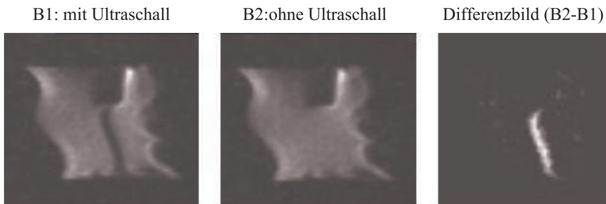
Abbildung 11.6: Dargestellt sind hier Aufnahmen mit einer Bewegungsempfindlichen NMR-Sequenz. Bei der Aufnahme B1 wurde der Ultraschall für 30ms mit einer Anregungsspannung von 40V-SS in die Probe eingestrahlt. Aufnahme B2 wurde unter gleichen Bedingungen ohne Ultraschall aufgenommen. Das Bild rechts ist die Differenz der Grauwertbilder B2 und B1.
