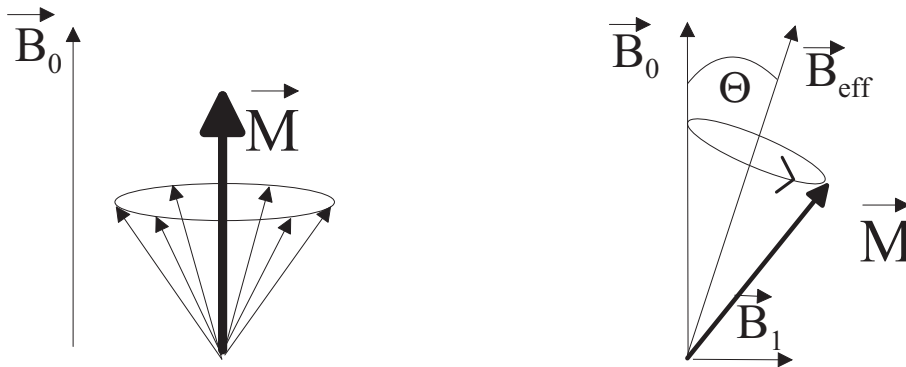
Abbildung 2.1: links: Gleichgewichtsmagnetisierung, rechts: effektive Magnetisierung bei zusätzlich angelegtem Wechselfeld
