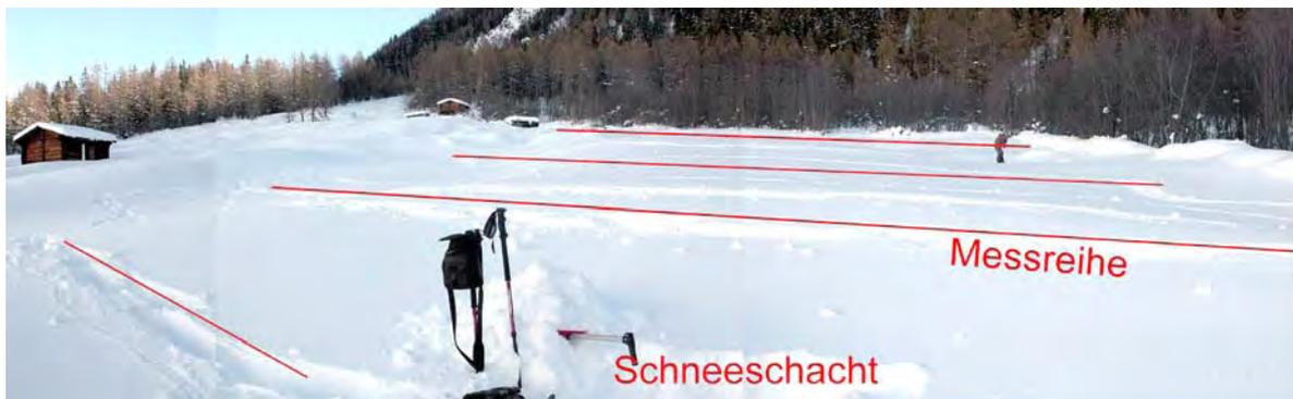
**Foto 4:** Beispielhafte Messanordnung auf einer Schneetestfläche. Entlang der rot gekennzeichneten hangparallelen Messreihen wurden die Schneetiefenmessungen durchgeführt. Im Schneeschacht wird das SWE bzw. die Schneedichte gemessen.
