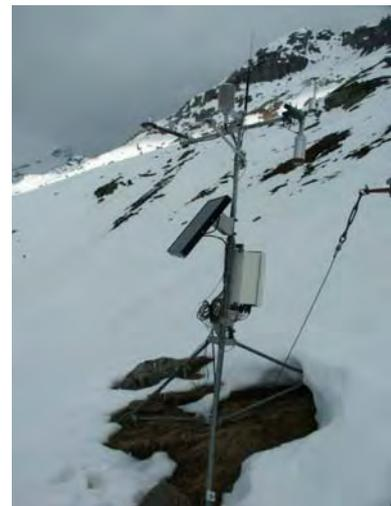
**Foto 3:** Klimastation Chumme (29.04.2003): verfrühte Ausaperung infolge der höheren Wärmeleitfähigkeit der Tripodstange
