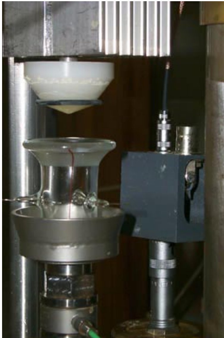
Abb. 3.2.3-1 Fotografie der Anordnung des Druckkopfes mit O-Ring zur Meßzelle
