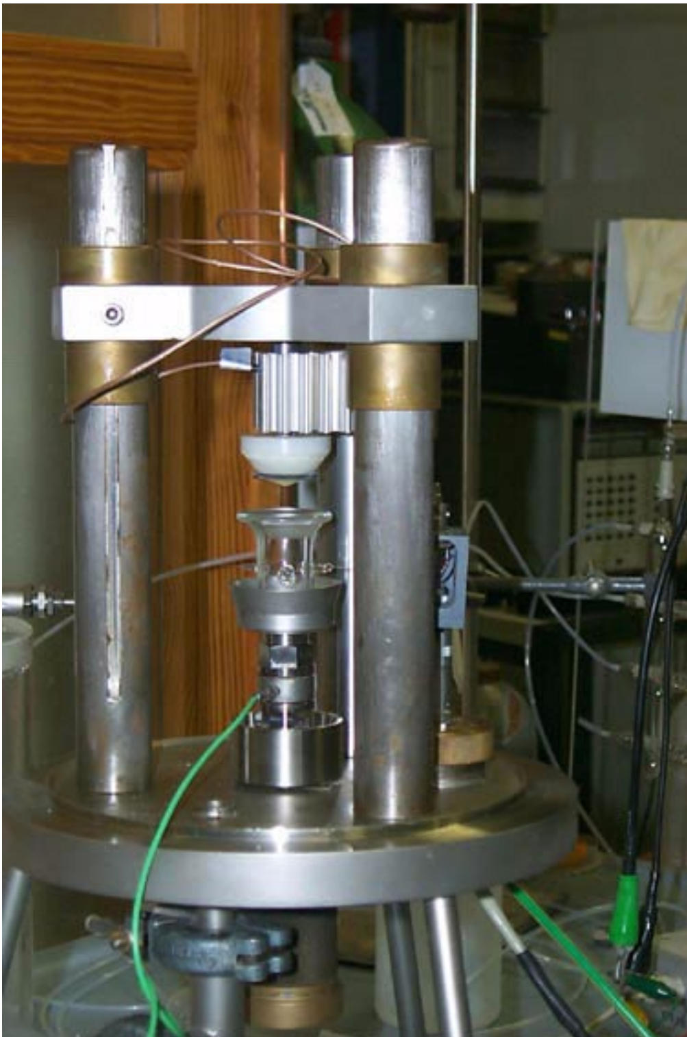
Abb. 3.2.1-1 Photografie des kompletten Aufbaus der Druckzelle ohne Einhausung zum Entlüften
