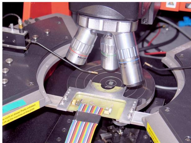
Abb. 4.3: Foto der Probestation mit Nadelkarte und MPEC-Chip
