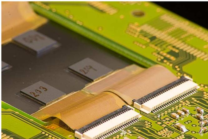
Abb. 6.6: Flex-Kabel Verbindung vom Dummy-Modul zur Detektor-Hybrid Platine
