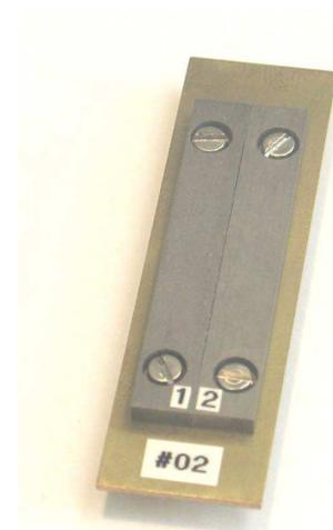
Abb. 5.9: Zwei Wolfram-Blenden (2,5 mm dick), die auf einem Messingrahmen aufgeschraubt sind, bilden einen 60  $\mu\text{m}$  breiten Spalt
