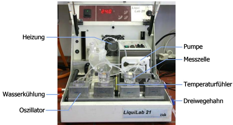
**Abbildung 26:** Das QCM-Messsystem LiquiLab 21. Gemessen wird bei konstanter Temperatur, die zu untersuchende Substanz wird von außen in das über Schläuche verbundene System gegeben.
