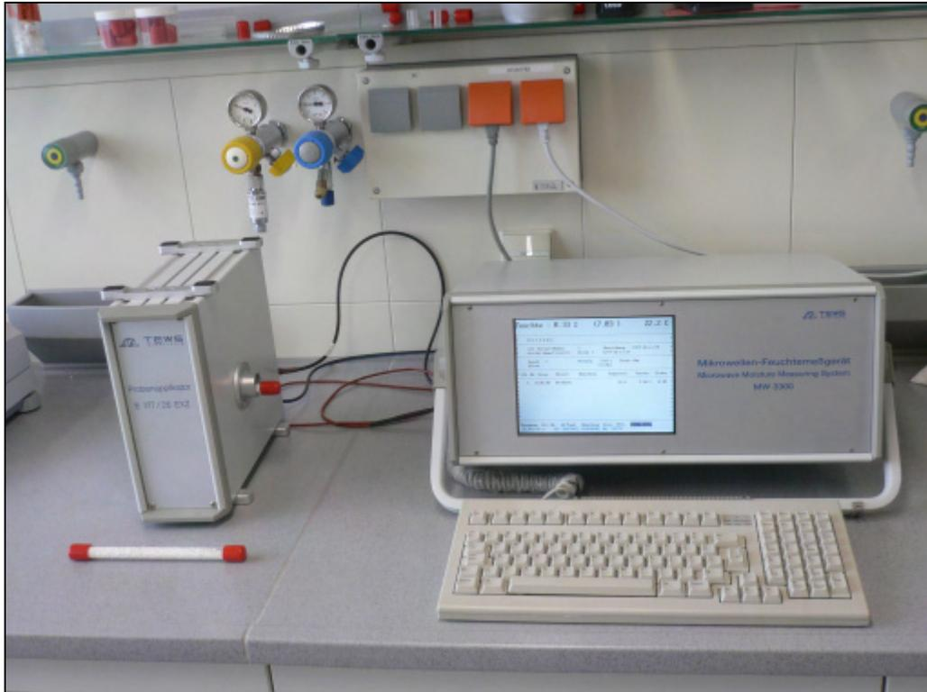
Abb. 3-1: Das Mikrowellen-Feuchtemesssystem MW3300 (TEWS Elektronik)
