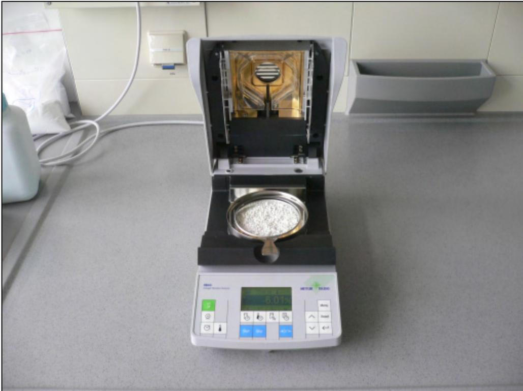
Abb. 3-2: verwendete Halogentrocknungswaage HB 43 (Mettler-Toledo)
