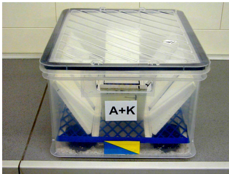
Abb. 6.3: Aufbewahrungsbox mit Fassadenprüfkörpern
