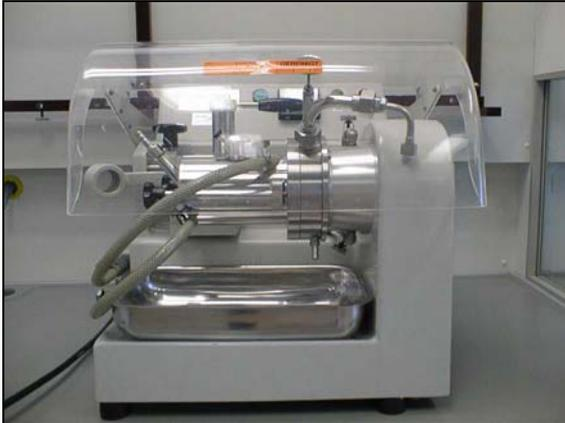
Abb. 15: Darstellung einer horizontalen, geschlossenen, kontinuierlichen Rührwerkskugelmühle, Dyno-Mill.
