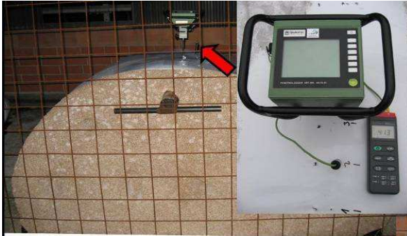
Abbildung 21: Untersuchungen zur Lagerungsdichte mit einem Penetrometer in vertikaler Einstichrichtung in Feuchtgetreide und –mais.
