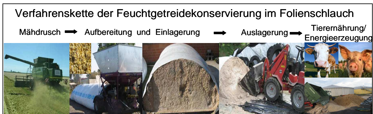
Abbildung 1: Verfahrenskette im Crimper-Bagger-Verfahren
