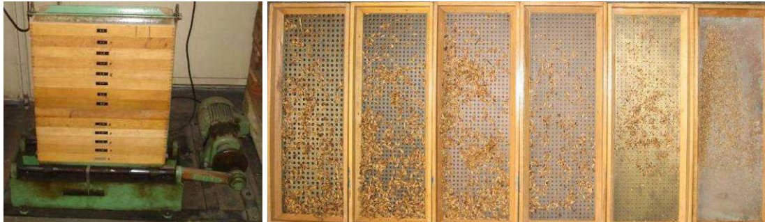
Abbildung 24: Siebfraktionierung mittels Siebturm (Aufbau links) in 6 Stufen (rechts).
