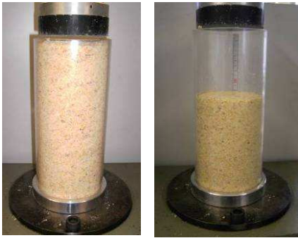
Abbildung 25: Untersuchung der Verdichtbarkeit von Feuchtgetreide in der Materialprüfmaschine. Links: vor Verdichtung von gequetschtem Feuchtmais, rechts: nach einmaliger Verdichtung.
