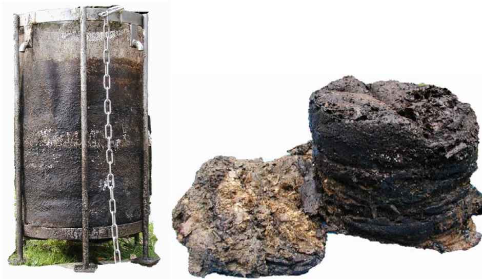
Abbildung 8.2: Aufbau und Inhalt der Filtersackanlage Lamberts-mühle.
