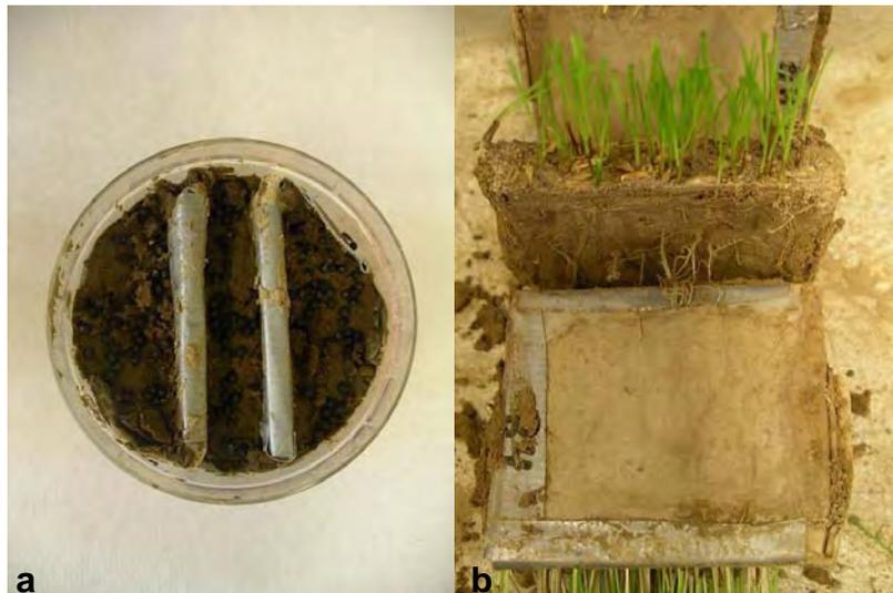
Abb. 3.3a - b: Diffusionstaschen, senkrecht im Versuchsgefäß [3.3a] bzw. nach der Ernte [3.3b]
