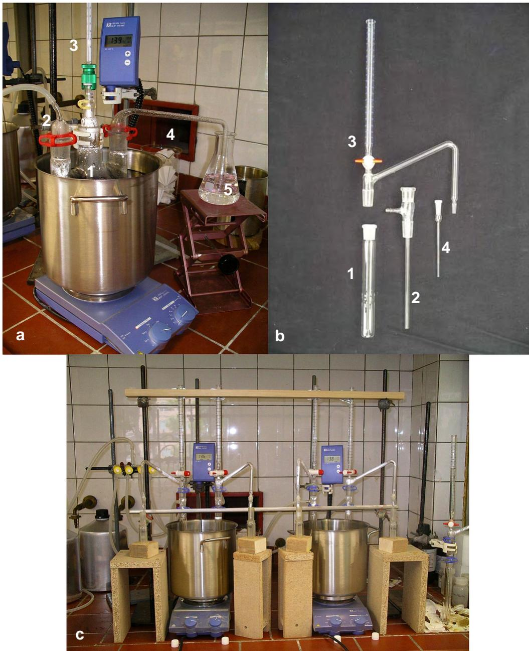
Abb. 3.2a - c: Apparatur zur Herstellung des HI-Säuregemisches [3.2a], Zusammensetzung der Versuchsapparatur bzw. Versuchsaufbau der HI-Reduktion [3.2b + 3.2c]
