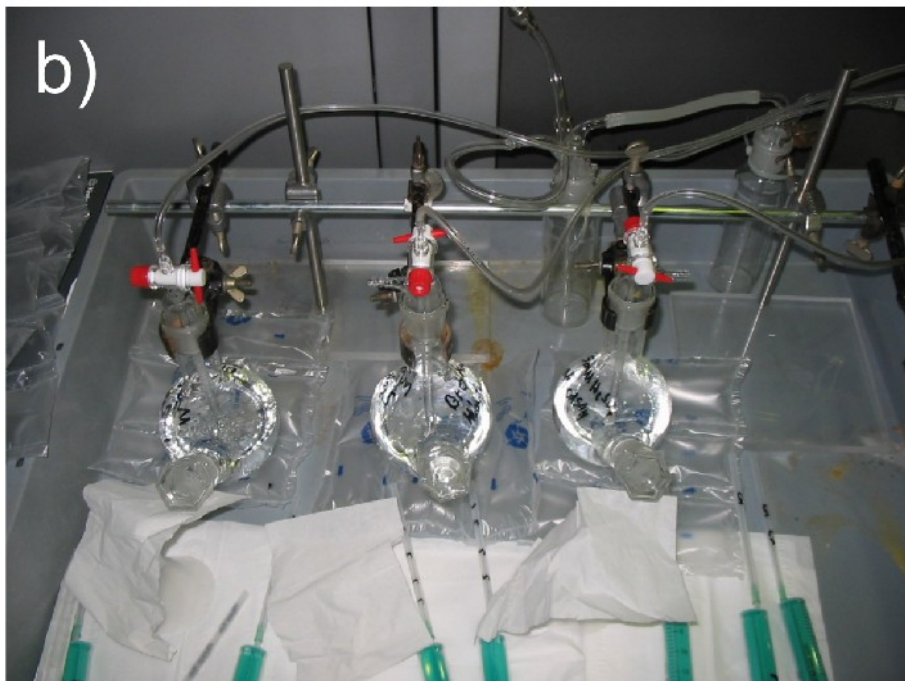
Abbildung 4.1.5: Aufbau der Elektrolytversorgung inkl. der Entgasung; (a) Frontansicht; (b) Detailansicht von oben.
