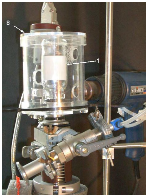
Abbildung 3-17: Trocknungseinheit des Fingerlyophilisators.
