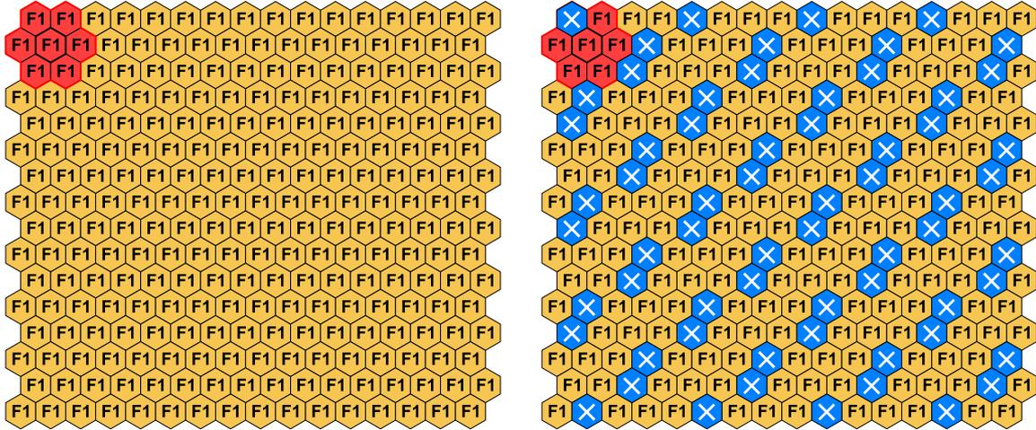
**Abbildung 5.9:** Dargestellt sind ein Ausschnitt eines homogenen Tilings mit dem Filtertyp F1 (links). Ein homogenes Tiling besitzt an jeder Hexagonposition eine Filterstützstelle des selben Typs. Rechts ist das homogene F1-Tiling dargestellt, wobei in diesem Fall allerdings an den Hexagonfeld-Positionen mit der Eigenschaft  $(x+y) \bmod 4 = 0$  die Filterstützstelle entfernt wurde. Dieses Tiling wird im Folgenden mit **homo F1-mod4** bezeichnet.
