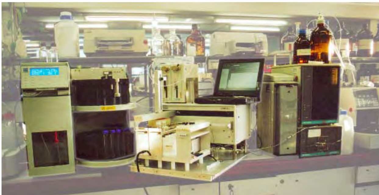
Abbildung 2.1-1: Kopplung von ASE, ASPEC und HPLC (von links nach rechts)
