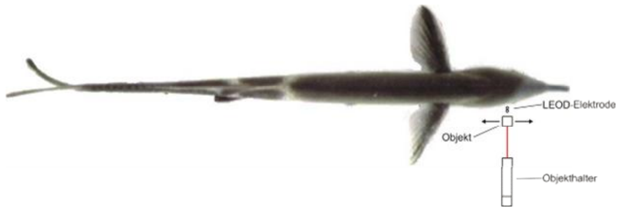
Abbildung 2-5: Versuchsanordnung während der Versuche der objektabhängigen Amplitudenmodulation. Die LEOD-Elektrode ist bei den Messungen stationär im Zentrum des rezeptiven Feldes des abgeleiteten Neurons verbleiben, während das Objekt in der Längsachse des Fisches durch das Zentrum des rezeptiven Feldes des Neurons bewegt worden ist, hier durch Pfeile angedeutet.
