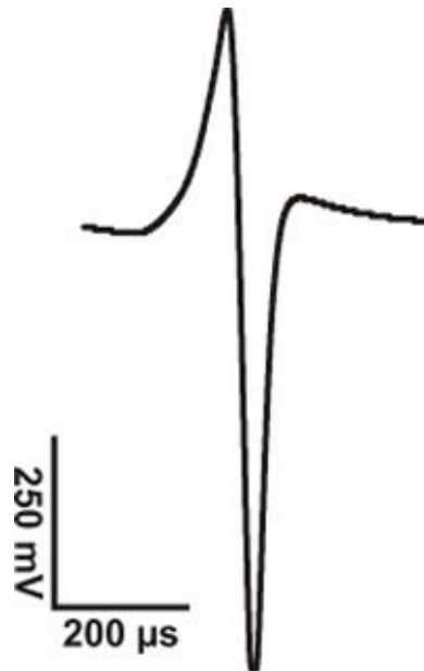
Abbildung 1-1: Beispiel einer biphasischen Entladung des elektrischen Organs (EOD) von G. petersii . Das EOD wurde mit zwei Ableitelektroden aufgenommen, die beide im Wasser vor und hinter dem Fisch positioniert waren.
