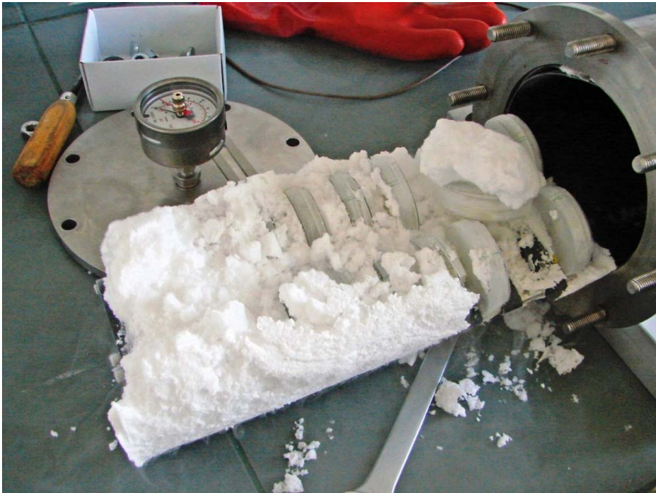
Abb. 6: Probenhalter nach dem Fixieren in einer Gefrierkammer. Das Bild zeigt den Probenhalter samt 60mm Petrischalen nach dem Übersprühen mit Trockeneisschnee. Deutlich zu erkennen ist, dass sich das Trockeneis um die eingesetzten Petrischalen absetzt und die Proben so schlagartig abgekühlt werden. Es können 20 Petrischalen á 60mm eingesetzt werden.
