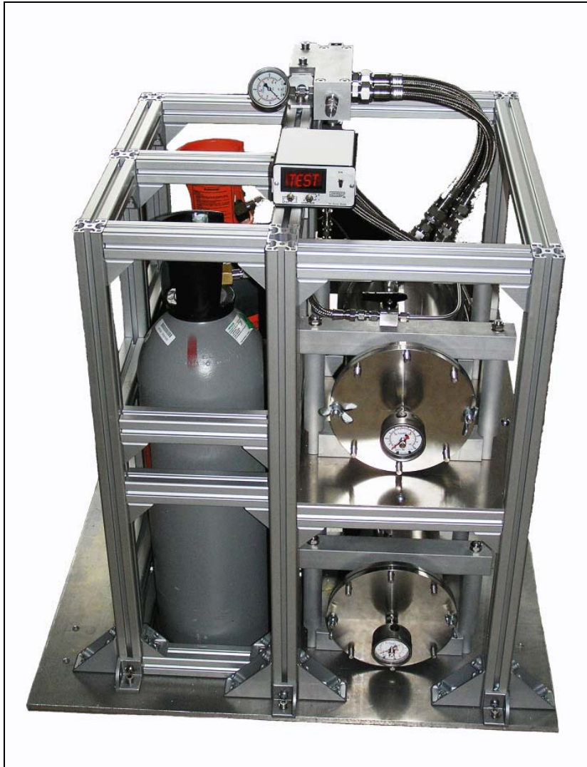
Abb. 5: Das Carbocryonix Rack im ungepolsterten Zustand. Auf einer Bodenplatte aus 10mm starkem Aluminium wurde eine Käfigstruktur aus 40x40mm ITEM Profilmaterial (siehe Anhang) mit einem zusätzlichen Zwischenboden aufgebaut. Im linken Teil sind zwei 10kg Kohlendioxid Steigrohrflaschen befestigt. Die rechte Seite beinhaltet zwei Gefrierkammern mit frontal angebrachten Manometern. Oberhalb der Struktur befinden sich eine Drucksammelbox, ein Thermometer zur Messung der Temperaturen in den Gefrierkammern sowie der erzeugten Abgase und ein Manometer zur Drucküberwachung.
