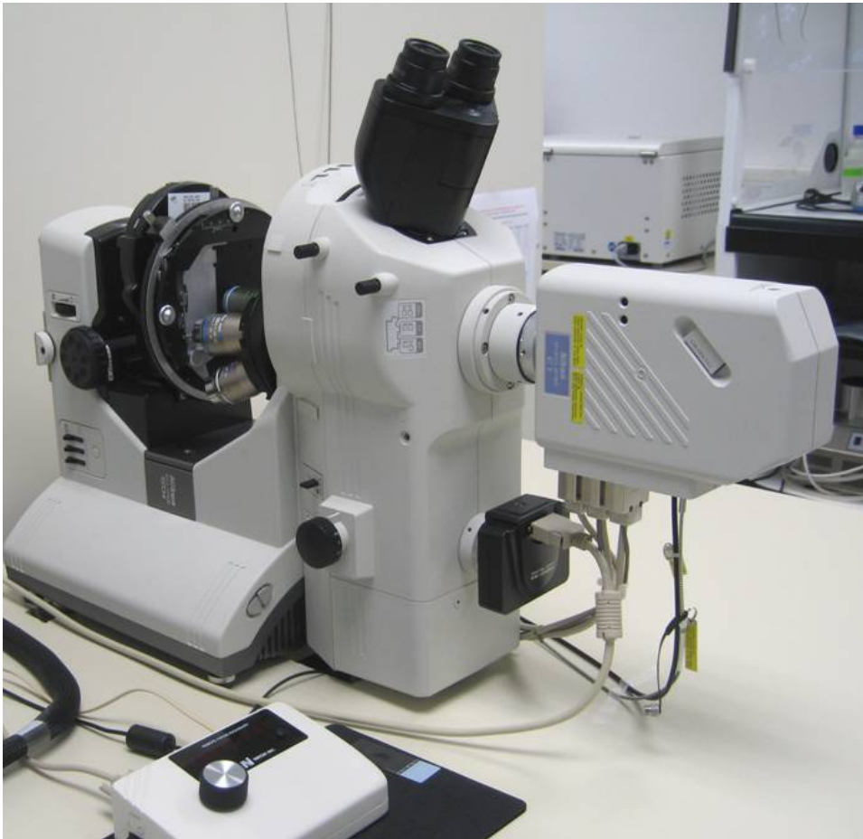
Abb. 7: NIKON Eclipse 80i "Horizontal" - Durch technische Modifikationen wurde es ermöglicht ein Laser-Scanning Mikroskop aus der Arbeitsposition um 90° zu drehen. Somit verläuft die optische Achse horizontal. Dies ermöglicht, gravisensitive Organismen in ihrer natürlichen Ausrichtung zu studieren. Ein drehbarer Objektisch ermöglicht es, die eingesetzten Organismen während der Beobachtung um bis zu 360° zu drehen.
