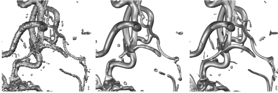
Abbildung 2: Glättung und Restaurierung eines MRA-Testdatensatzes (links das Original) mit dem isotropen volumenerhaltenden Krümmungsfluss (Mitte) und mit unserer anisotropen Methode (rechts).
