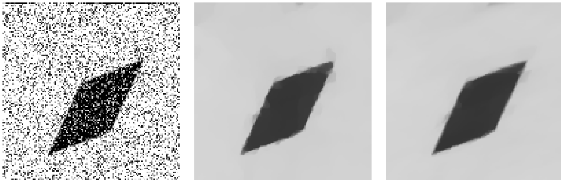
Abbildung 18: Gleiche Situation wie in Abbildung 17, hier allerdings mit einem rotierten Parallelogramm. Die Verminderung der Artefakte durch das anisotrope Verfahren ist nicht mehr ganz so stark wie dort, aber immer noch deutlich vorhanden.
