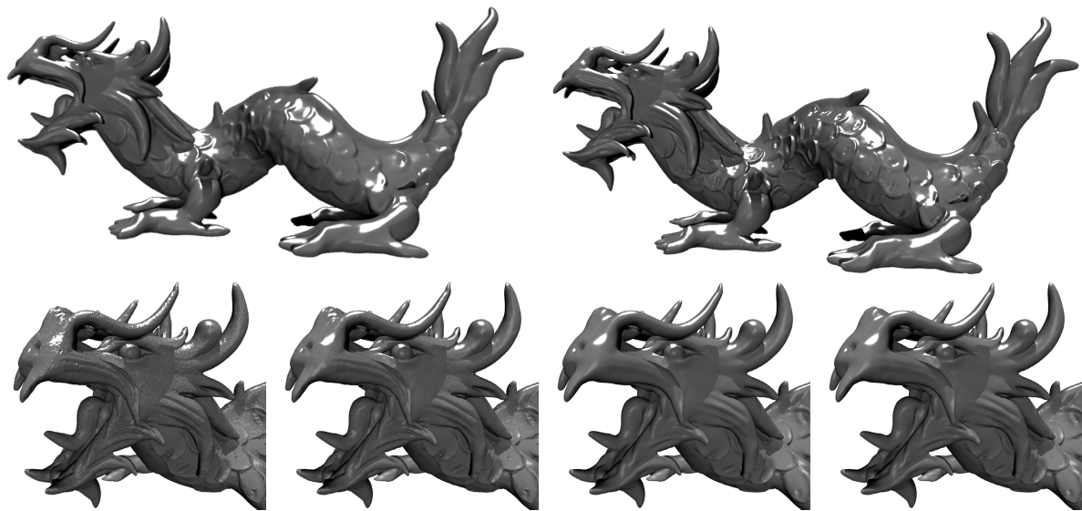
Abbildung 65: Vergleich des mittleren Krümmungsflusses mit der anisotropen geometrischen Diffusion nach 30 Zeitschritten mit \tau = h^2 (obere Zeile). In der unteren Zeile sind Vergrößerungen des Kopfbereiches unter anisotroper geometrischer Diffusion zu den Zeitschritten 0, 7, 30 und 47 zu sehen.
