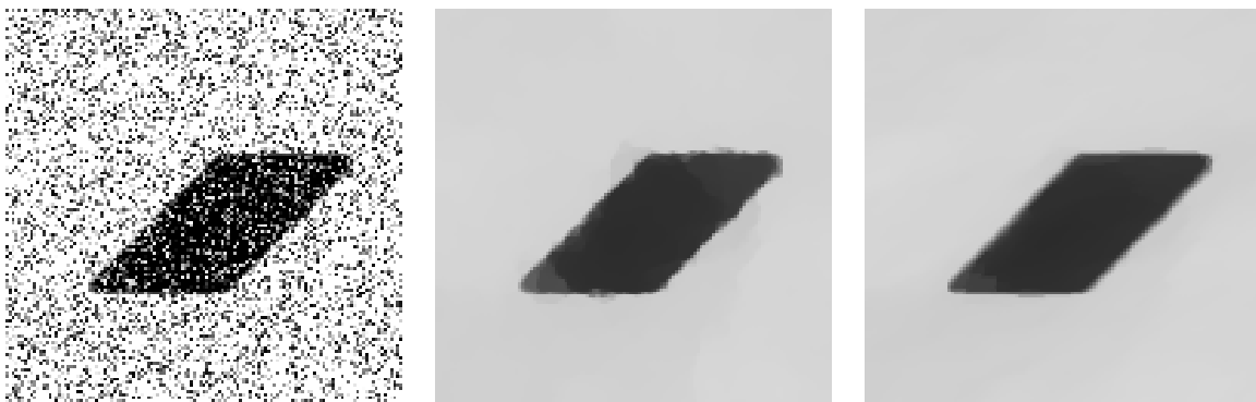
Abbildung 19: Hier sollte eine im Originalbild nicht vorhandene scharfe Ecke generiert werden. Die Glättung (rechts) ist zwar besser als im isotropen Fall (Mitte), die Restaurierung der Ecken unterscheidet sich aber nur unwesentlich.
