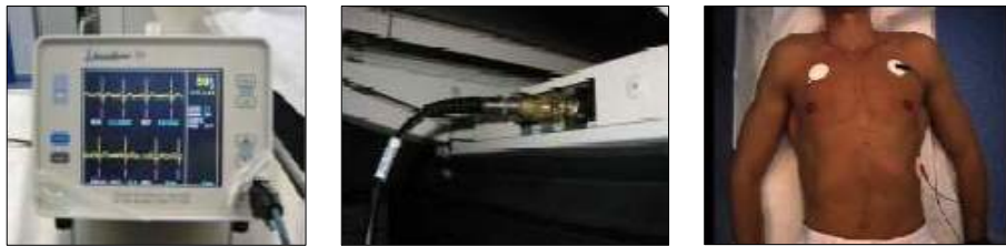
Abbildung 2: Anschluss des EKG Monitors am CT-Tisch; Position der EKG-Elektroden
