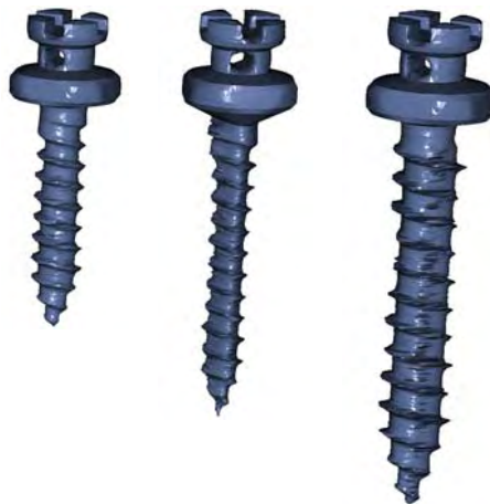
Abbildung 7: LOMAS FE-Modelle. Links: 7 mm x 1,5 mm, Mitte: 9 mm x 1,5 mm, rechts: 11 mm x 2 mm.
