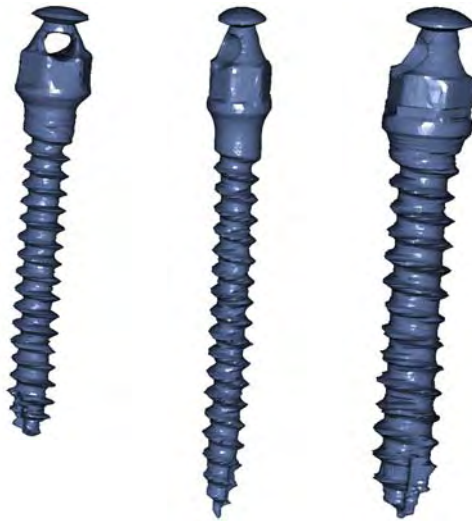
Abbildung 5: AbsoAnchor ® Micro Implant FE-Modelle. Links: 10,5 mm x 1,4 mm, Mitte: 12,5 mm x 1,2 mm, rechts: 12,5 mm x 1,6 mm.
