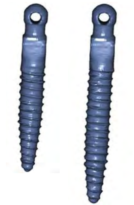
Abbildung 8: IMTEC Mini Ortho Implant FE-Modelle. Links: 8 mm x 1,8 mm, rechts: 10 mm x 1,8 mm.
