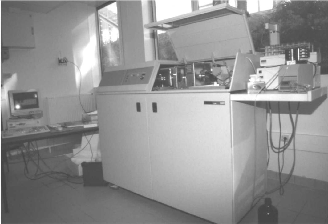
Abb. 6: Induktiv gekoppeltes Plasma Massenspektrometer (SCIEX ELAN 5000, Perkin Elmer)
