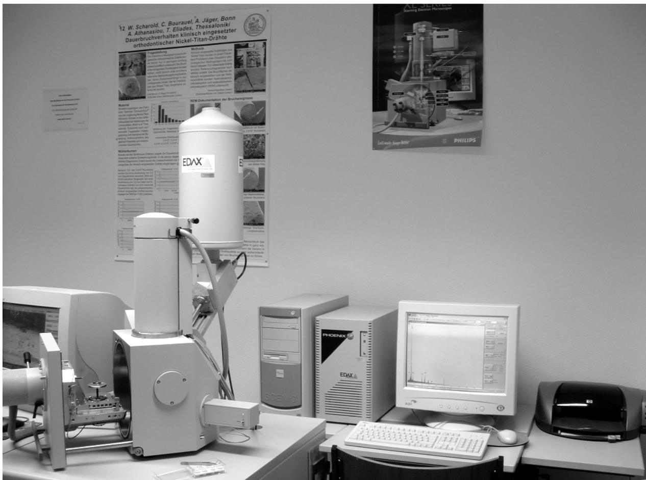
Abb. 11: Das Rasterelektronenmikroskop (Philips XL 30)
