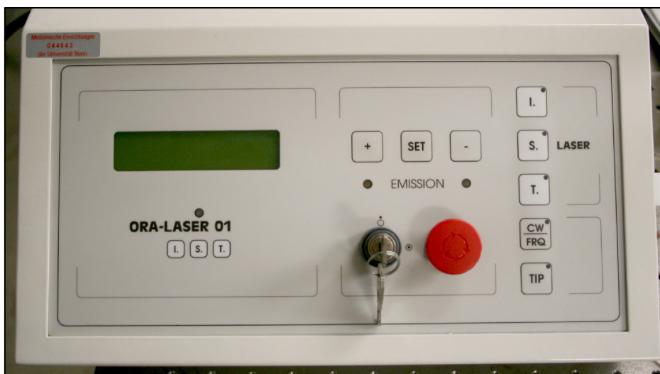
Abb. 8: ORA-Laser 01 I.S.T.®: Diodenlaser mit einer Wellenlänge von 809 nm
