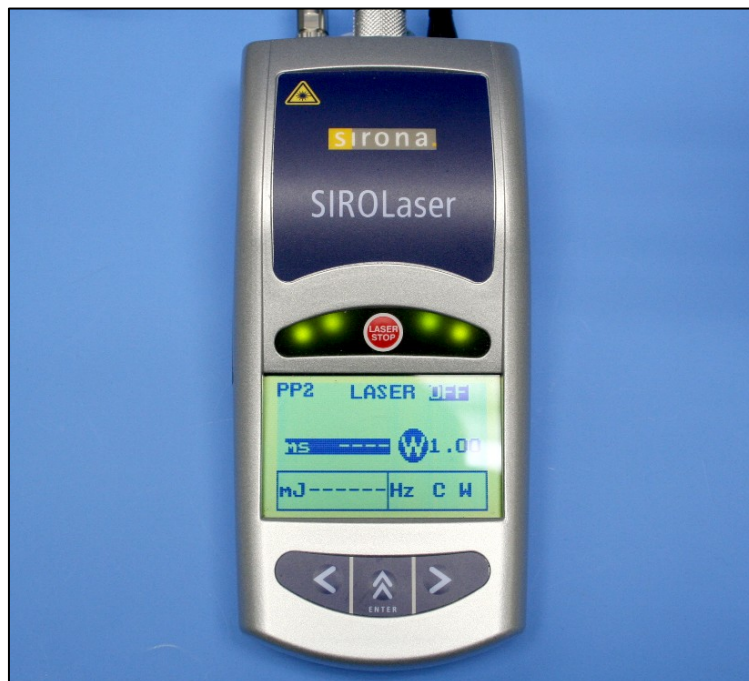
Abb. 7: SIROLaser®: Diodenlaser mit einer Wellenlänge von 970 nm
