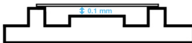
Abbildung 4: Schematische Darstellung der Neubauer-Zählkammer, Seitansicht mit aufgelegtem Deckglas (nach: http://e-learning.studmed.unibe.ch/hemosurf_demo/Demo_D/Lab/count_manual.htm ; Zugriff am 09.01.2008); blau = Kammertiefe
