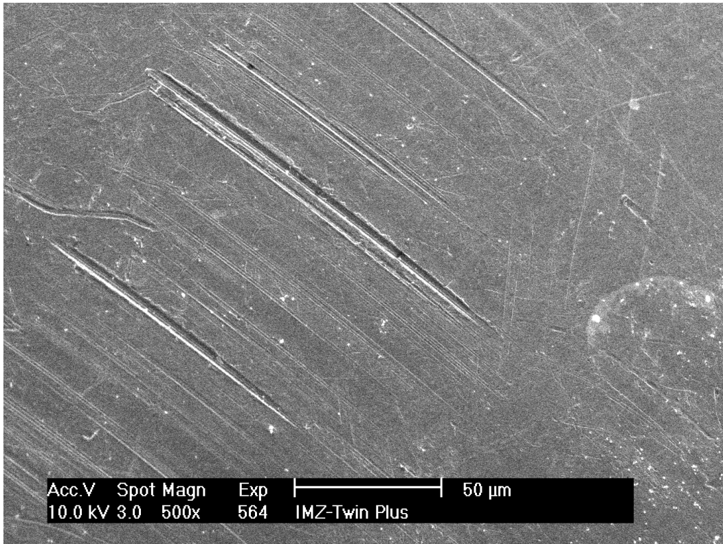
Abb. 52: IMZ ® Twin Plus Patrizie nach Verschleiß: Abrasion und tribochemische Reaktion
