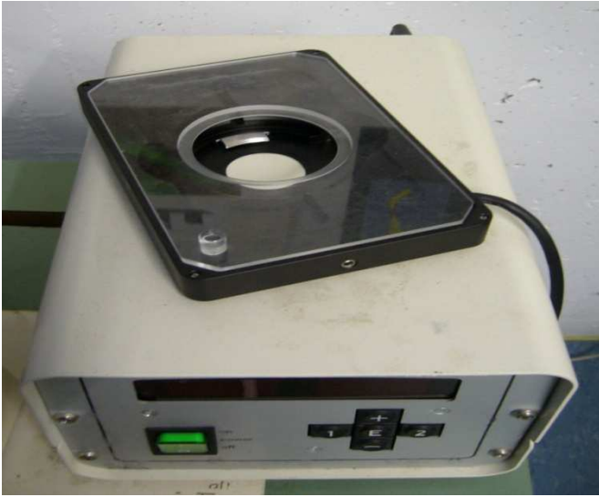
Abb. 3: Beheizbarer Objektschlitten mit CO 2 -Atmosphäre und Reglereinheit. An der Reglereinheit ist die Temperatur einzustellen. Im Objektschlitten befindet sich das Thermostat.
