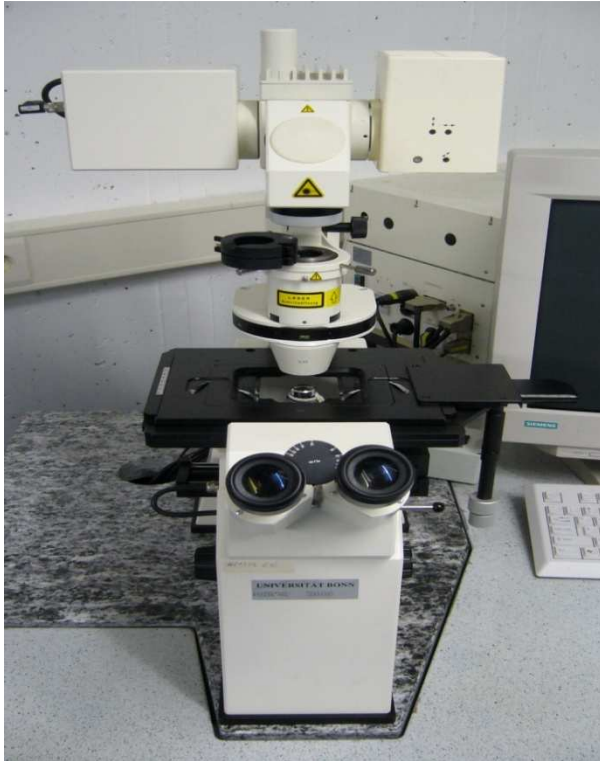
Abb. 4: Zeiss LSM 510 Meta mit Axiovert Scannereinheit. Der Computer rechts im Bild dient der Steuerung und Programmierung, sowie Lagerung und Auswertung der Bildinformation.
