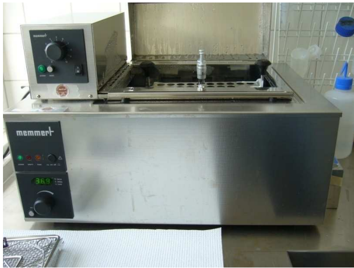
Abb. 6: Schüttelbad zur Gewinnung der Mikroorganismen. In verschlossenen Reagenzgläsern durchlaufen die Populationen hier die lag- und die exponentielle Phase.
